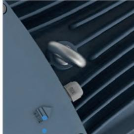
Doté d'écrous à œil pour le soulèvement [1 pour le B3 (montage à pattes), 2 pour le B5 (montage à bride)]
