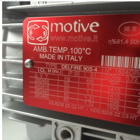
Die verwendete Technologie findet ihren Ursprung in den EN 12101-3 Motoren für die Rauchentsorgung. Allerdings, anstatt nur im Notfall ein paar Stunden zu funktionieren, sind die Delfire Motoren für den Dauerbetrieb S1 ausgelegt und haben die gleiche Lebensdauer eines normalen Motors. Die verschiedenen Funktionen sind unter anderem::
