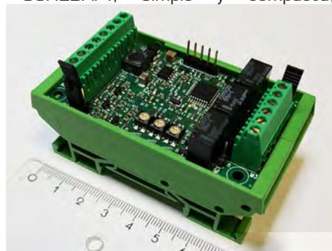
permite el montaje del dispositivo en una guía DIN. Tensión de alimentación: 5 ÷ 30Vdc max 100mA.
