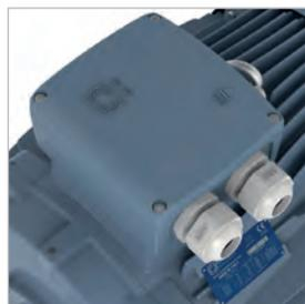
Manteniendo el mismo sistema de retenes de toda la serie Delphi, la caja de bornes hasta el tamaño 280 está fabricada en aluminio, lo cual garantiza el índice de protección IP65 sin ser afectado por los acabados habituales de la fundición.
