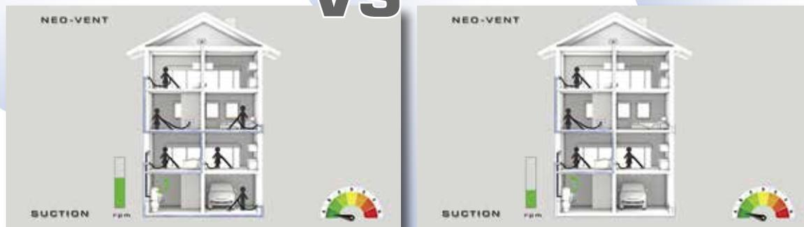
con **NEO-VENT** la velocità si riduce in base al numero di utenze. La potenza consumata si riduce esponenzialmente rispetto alla riduzione della velocità
