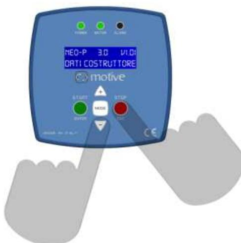
La procedura di reset non va a interferire con l'impostazione dei canali di comunicazione e frequenza.
