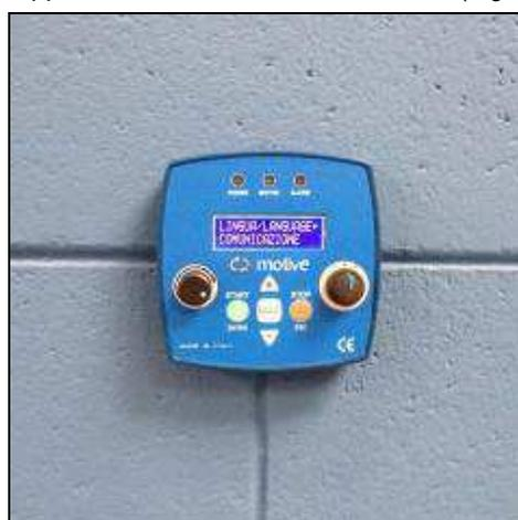
Ogni tastiera viene fornita già provvista di due batterie ricaricabili tipo 250BVH (Diametro=25mm, altezza 6.4mm, 1.2 Vdc, 250 mAh).
