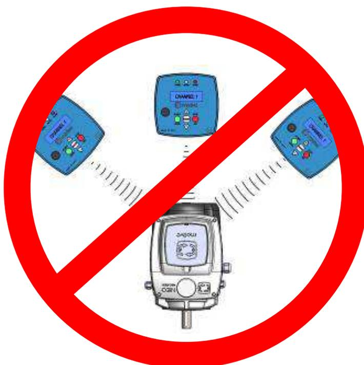
**I SEGUENTI PUNTI 5-6-7 SONO DA SEGUIRE SOLO SE DOVETE MODIFICARE IL CANALE DI COMUNICAZIONE O LA FREQUENZA DELLA TASTIERA (da eseguire quando più NEO-PUMP lavorano nello stesso ambiente per evitare interferenza):**
