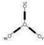
wenn auf dem Typenschild des Motors 230V $\Delta$ /400VY (Abbildung 9) angegeben wird.
