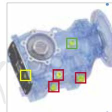
5个可互换的塞头,包括一个呼吸塞和一个油面插头。请注意,呼吸塞还可以降低密封件的内部压力,从而提高减速机效率。
