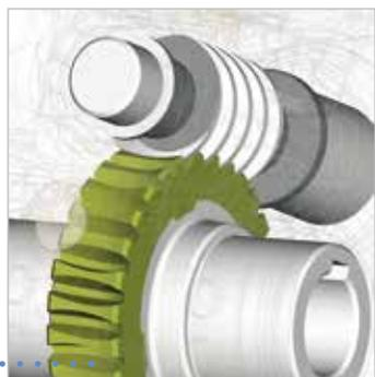
为了提高静音，效率和持续时间，蜗杆轴采用淬硬钢和地面加工而成，而蜗轮采用壳体铸造ZCuSn12青铜。
