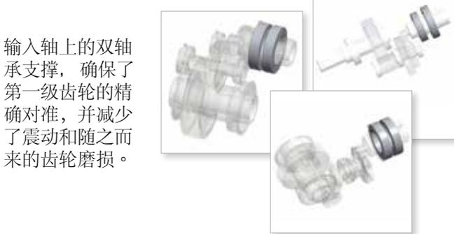
输入轴上的双轴承支撑，确保了第一级齿轮的精确对准，并减少了震动和随之而来的齿轮磨损。
