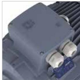
保留了整个DELPHI系列相同的密封系统, 机座号160-280的接线盒由铝合金制成, 从而保证其IP65防护等级不受铸铁常见的加工精度缺陷所影响。
