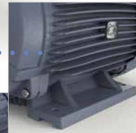
在高转矩情况下, 通过与机壳一体铸造的底脚确保尺寸180以上的电机固定强度
