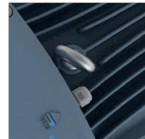
配备吊环螺栓[一个用于B3版本(脚固定)，两个用于B5版本(法兰)]
