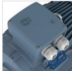
保留了整个DELPHI系列相同的密封系统，尺寸280的接线盒由铝制成，从而保证其IP65防护等级不受铸铁常见的加工精度缺陷所影响。
