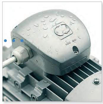
A fin de garantir une étanchéité optimale, la boîte à bornes a été dotée de presse-étoupe anti-arrachement et les roulements ont été dotés d'une bague à lèvres servant à protéger les deux côtés du moteur.
