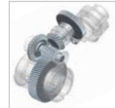
Döner dislilerdeki aşınma oranını azaltmak için yüksek dayanıklı  $58 \pm 2$  HRC sertleştirilmiş çelikler kullanılmıştır. Tüm döner disliler, düşük ses ve yüksek verimlilik için 6. sınıf (DIN 3962) hassasiyeti kullanılarak duzeltilmiştir.
