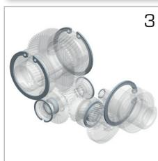
Mekanik parçalar, konumlarında klipslerle kilitlenmiştir. Bu aynı zamanda eksenel itme kuvvetinin daha iyi emilmesini sağlar ve rulmanların ömrünü uzatır.
