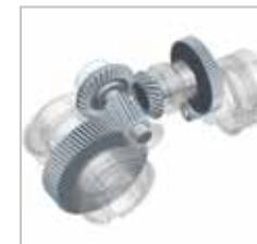
Tek aşamalı oranlar 2 ile 6 arasındadır ve uygun diş boyutları ile birlikte, matematiksel olarak her dönen dişlinin daha yüksek diş sayısı ve boyutu (modül) ile sonuçlanır ve redüksiyon aşamaları arasında daha iyi bir yük bölünmesi sağlar. Bu, hem dayanıklılığı hem de tork iletimini etkiler.
