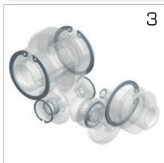
3 Các bộ phận cơ khí được khóa ở vị trí của chúng bằng các vòng chặn và các miếng đệm. Điều này cũng giúp hấp thụ tốt hơn lực đẩy trực và kéo dài tuổi thọ của vòng bi.
