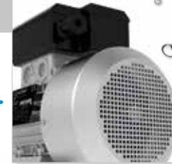
A fin de garantir une étanchéité optimale, la boîte à bornes a été dotée de presse-étoupe anti-arrachement et les roulements ont été dotés d'une bague à lèvres servant à protéger les deux côtés du moteur.
