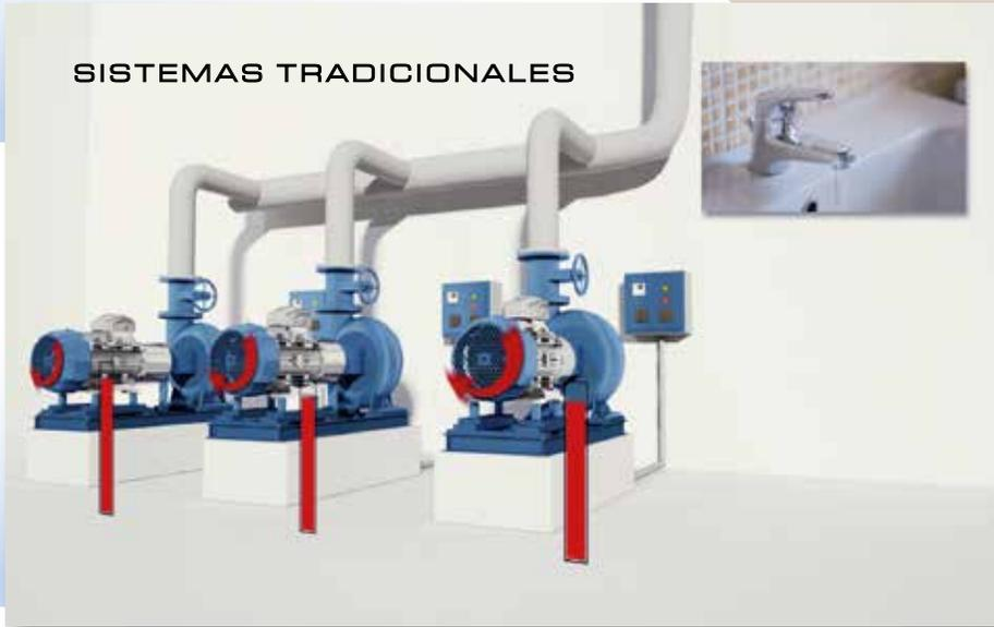
Con los sistemas tradicionales, el consumo energético es la suma de las potencias nominales del total de las bombas instaladas, sin importar cuál es el consumo de caudal necesario o utilizado instantáneamente
