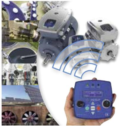
**Evolución del famoso inverter con control remoto “NEO-WIFI”, NEO-VENT controla la presión del aire en el sistema para mantenerla constante, ajustando automáticamente la velocidad del motor y el consumo de potencia del sistema de ventilación, climatización y aspiración en aplicaciones en ambientes residenciales e industriales, en base al flujo de aire demandado en cada momento por el número de usuarios.**
