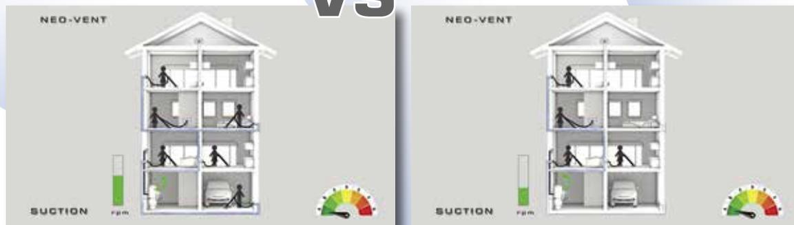
con **NEO-VENT**, la velocidad se reduce en base al aire requerido. De esta manera, la potencia consumida se reduce exponencialmente con respecto a la reducción de velocidad.
