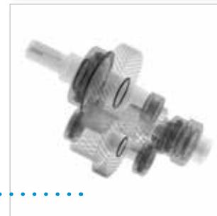
les parties en mouvement sont fixées dans leur position par des bagues élastiques et des entretroises. Ceci permet l'absorption des plus grandes charges axiales des montages verticaux et prolonge la durée de vie des roulements.
