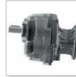
Використання високоміцної сталі та загартування до  $58 \pm 2$  HRC знижують інтенсивність зносу коліс шестерен. Всі колеса профілюються з точністю до 6 класу Din 3962, що забезпечує низький рівень шуму та високу ефективність.
