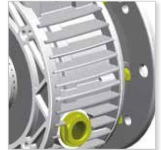
闭式输入法兰是VARIO外壳的组成部分，可防止漏油。
