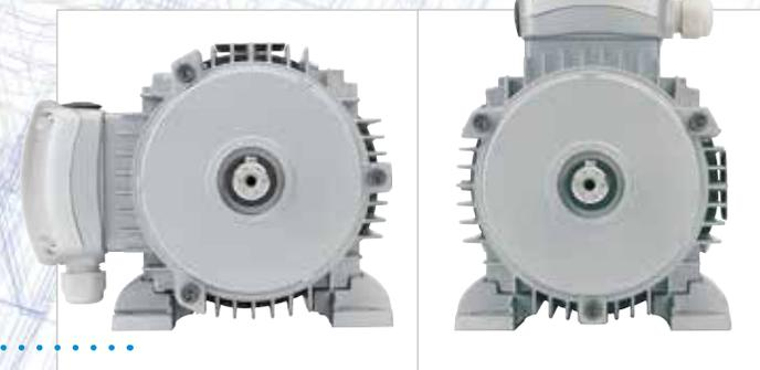
由尺寸56到尺寸132, 支脚可拆卸，并可以固定在外壳的三个侧面上，从而允许接线盒向上、向右或向左定位。
