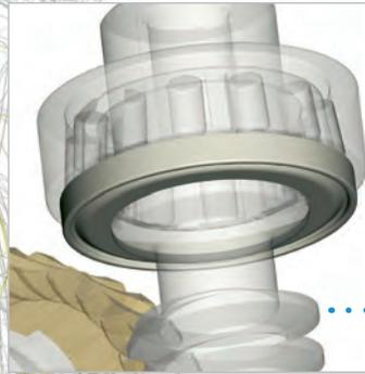
Inoltre, l'abbinamento dei 2 cuscinetti a rulli conici con 2 nilos (montati dal tipo 75 per garantire una buona lubrificazione anche del cuscinetto che non è bagnato dall'olio) permette il montaggio dell'intera gamma, dalla taglia 25 alla taglia 150, in posizione V5 e V6, senza alcuna modifica del riduttore.
