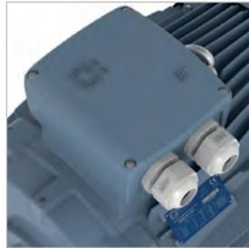
Mantenendo lo stesso sistema di chiusura di tutta la linea delphi, la cassetta connessioni garantisce un IP65, in alluminio fino alla taglia 280 per non risentire dei consueti difetti di forma delle fusioni in ghisa
