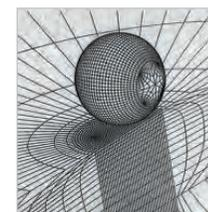
La superficie degli ingranaggi più sollecitati viene bombardata con microsferiche che inducono compressione ed aumentano ulteriormente la resistenza alla fatica.
