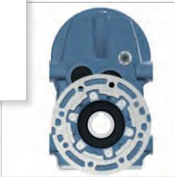
Design modulare con flangia di uscita staccabile e piedi integrati permette la conversione facile e veloce tra il piede e il montaggio a flangia
