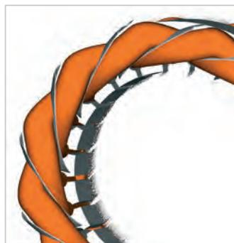
L'avvolgimento è eseguito con filo di rame protetto da una vernice a doppio smalto tropicalizzante, che garantisce una elevata protezione alle sollecitazioni. Un film separatore di rinforzo tra le fasi protegge il motore dagli elevati picchi di tensione che si hanno tipicamente con l'alimentazione tramite inverter
