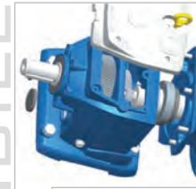
Flangia ed albero cavo di entrata normalizzati IEC permettono il montaggio diretto di motori standard
