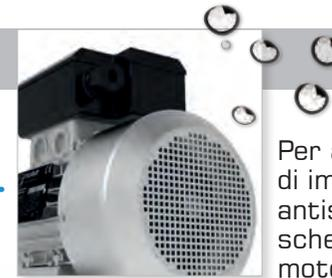
Per assicurare la loro ermeticità sono dotati di importanti dettagli come i pressacavi antistrappo e l'abbinamento di cuscinetti schermati e paraolio su entrambi i lati del motore
