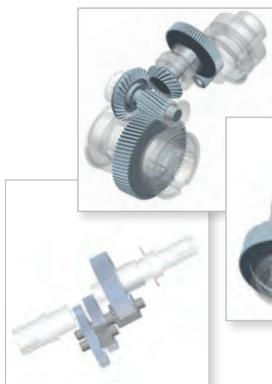
L'uso di acciai tenaci e trattamenti di indurimento a  $58 \pm 2$  HRC riducono il tasso di usura degli ingranaggi. Tutti gli ingranaggi cilindrici sono rettificati con una precisione di classe 6 (DIN 3962) per ottenere silenziosità e rendimento.
