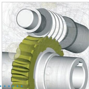
A fin de mejorar el nivel de ruido, rendimiento y duración, el eje tornillo sinfín está fabricado en acero tratado, mientras que la corona está fabricada en aleación de bronce ZCu-Sn12.
