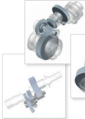
El uso de aceros duros y tratamientos de endurecimiento a  $58 \pm 2$  HRC reducen los niveles de desgaste de los engranajes. todos los engranajes cilíndricos son rectificadas con una precisión de clase 6 (DIN 3962) para obtener silencio y rendimiento
