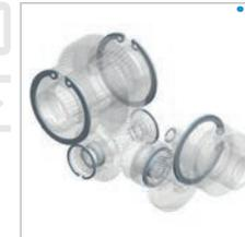
las partes en movimiento están aseguradas en su posición por anillos elásticos y espaciadores. Esto permite absorber las mayores cargas axiales de los montajes verticales y prolonga la vida de los cojinetes.
