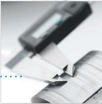
Las láminas no son de un hierro común Fe PO1, sino magnéticas FeV; ello permite garantizar elevados rendimientos, menor recalentamiento, ahorro energético y una duración superior de los materiales aislantes.
