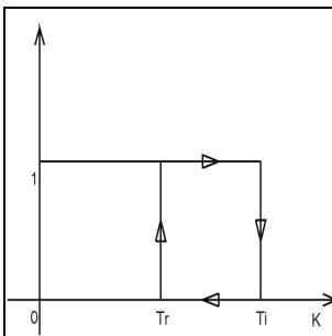
Tr= opening temperature (il motore si ferma)
