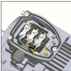
Il collegamento a triangolo si ottiene collegando la fine di una fase all'inizio della fase successiva.
