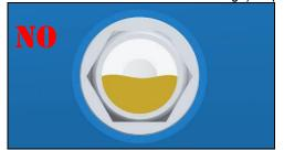
Nur in Position V5/V1, begrenzt auf die Größen ROBUSA2, 25 und 60, versichert di Bedeckung des Füllstandstopfens die korrekte Anwesenheit der Ölmenge nicht. Eine korrekte Ölmenge erlaubt, alle offenen Getriebe und Lager einzufetten. In diesen Fällen kann man deshalb, oder falls die Montage des Füllstandstopfens aus mechanischer Behinderung (möglich bei der Montage von B7 oder V5) nicht durchführbar ist, die korrekte Ölmenge mit einem Meßstab prüfen.
