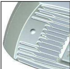
Daya yang dapat digunakan tidak hanya bergantung pada karakteristik elektronik NEO-WiFi, namun juga pada kapasitas disipatif casingnya. Oleh karena itu, tidak diperbolehkan menggunakan papan elektronik dalam wadah yang berbeda dari aslinya dengan melepas papan elektronik dan memasangnya pada wadah lain. Pengalihan ini juga akan membahayakan insulasi listrik dan keamanan perangkat sehingga garansi tidak dapat diterapkan
