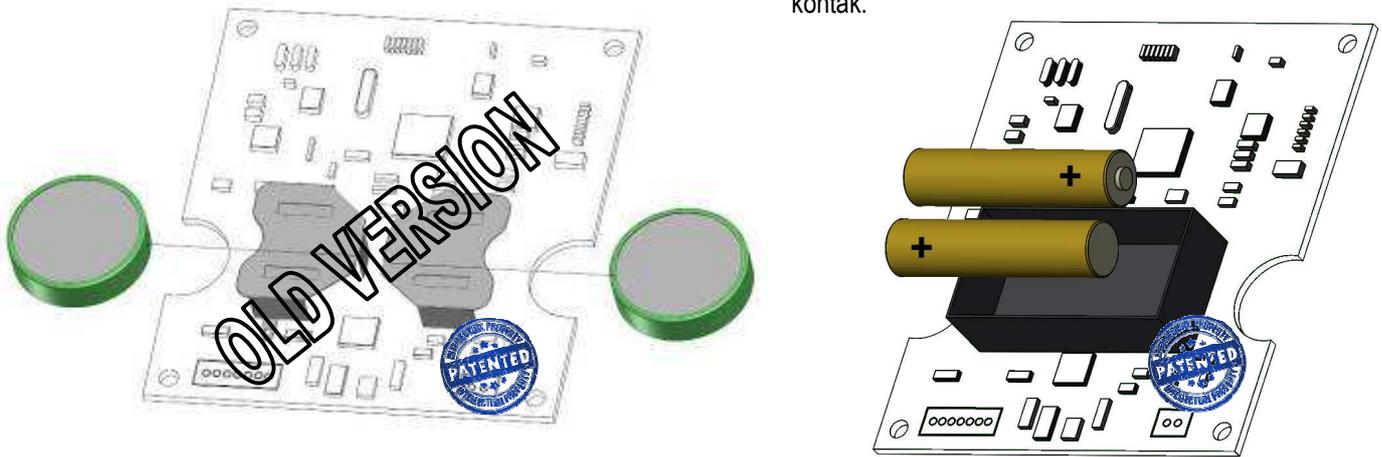
Di hadapan pemilih dan potensiometer, 4 sekrup M3 yang ada di bagian atas papan display harus dibuka. Ekstrak agar baterai dapat dilepas dan diganti; di akhir operasi ini, papan harus dipasang kembali ke penutup papan tombol.
